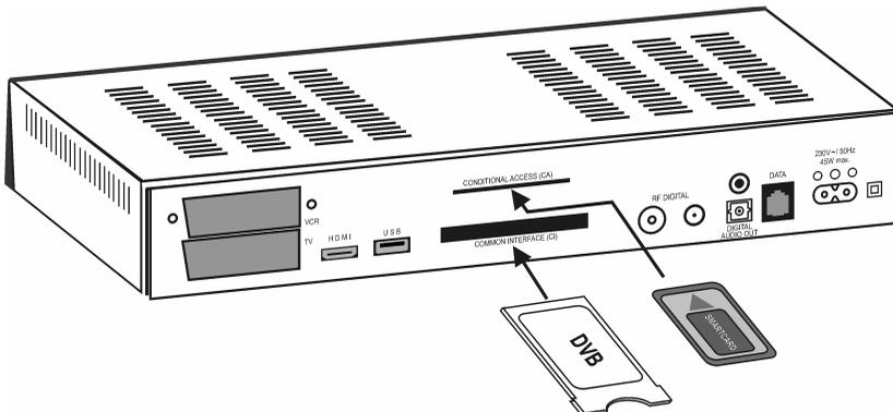
Nachdem das Modul und die Smart Card eingesetzt sind, kann das entsprechende Programm ausgewählt werden. Es kann einige Sekunden dauern, bis das Programm freigeschaltet wird.
